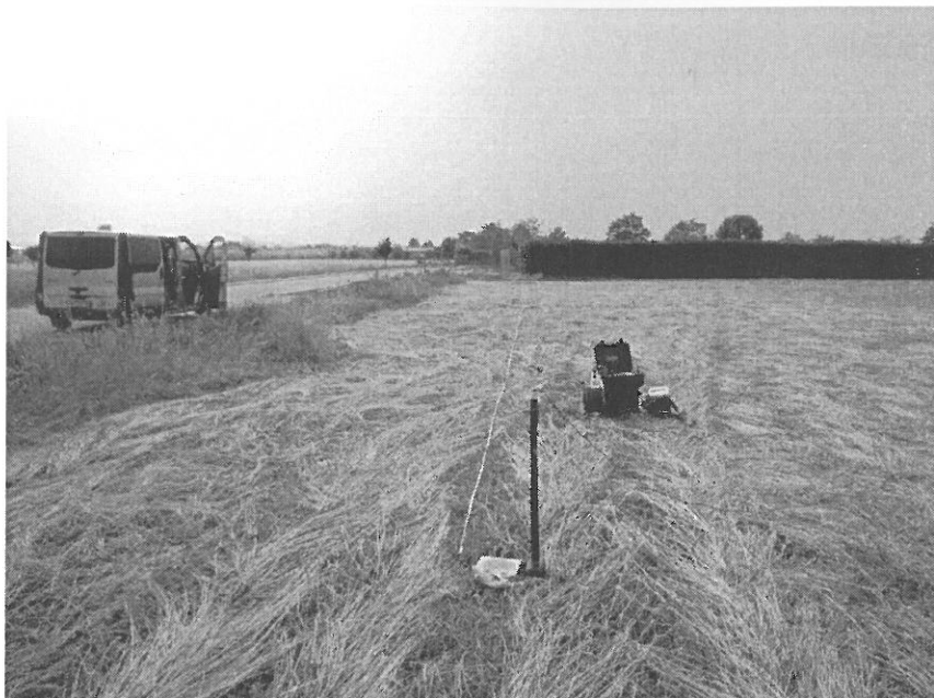
Foto 1: Esecuzione dello stendimento sismico
