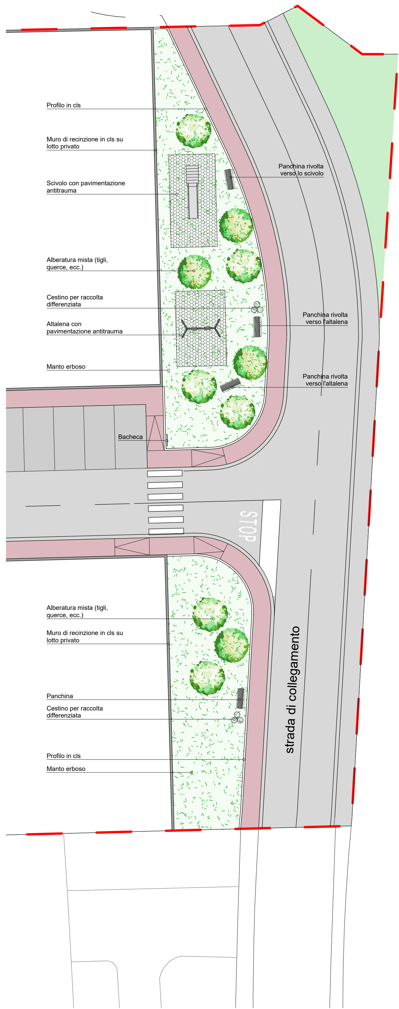
PARTICOLARE SISTEMAZIONE AREA VERDE scala 1:200
