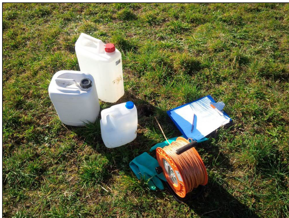
Foto n°2: Prova di conducibilità idraulica in foro di sondaggio (K1)
