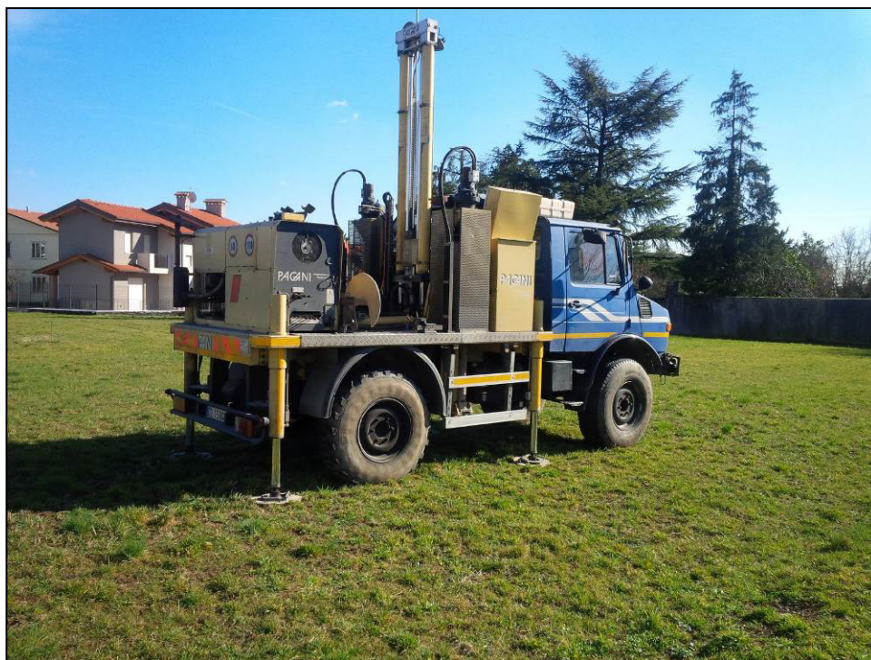
Foto n°1: prova penetrometrica dinamica superpesante (DPSH 1)
